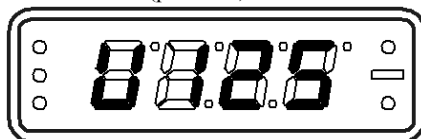
Рис. 6.8а – Напряжение питания (12,5 В)
